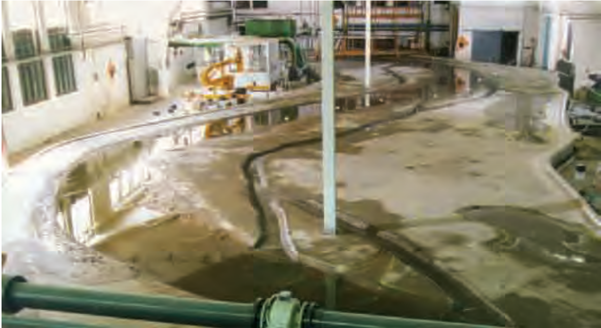
Bild 18: Blick in Fließrichtung auf das hydraulische Modell „Mockritz-Döbern“ bei Q = 580 \text{ m}^3/\text{s} . Im Vordergrund die Zuläufe zur Rinne des rechten Vorlandes.
