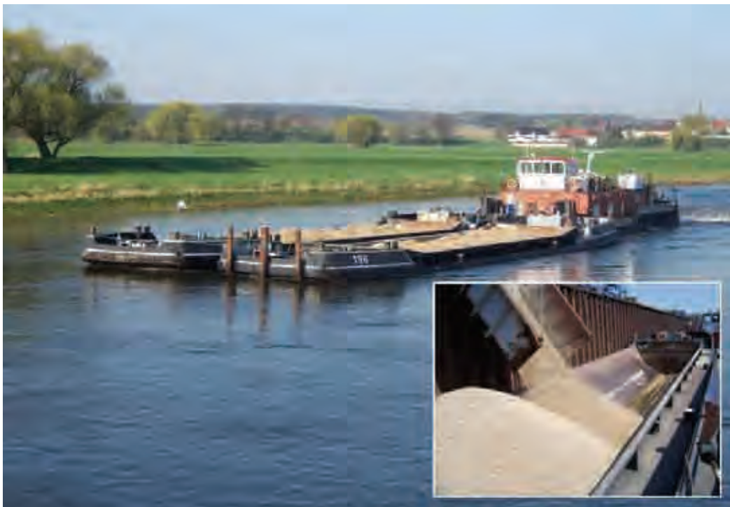
Bild 22: Schubeinheit mit zwei gekoppelten Hydroklappschuten beladen mit Geschiebezugabematerial
