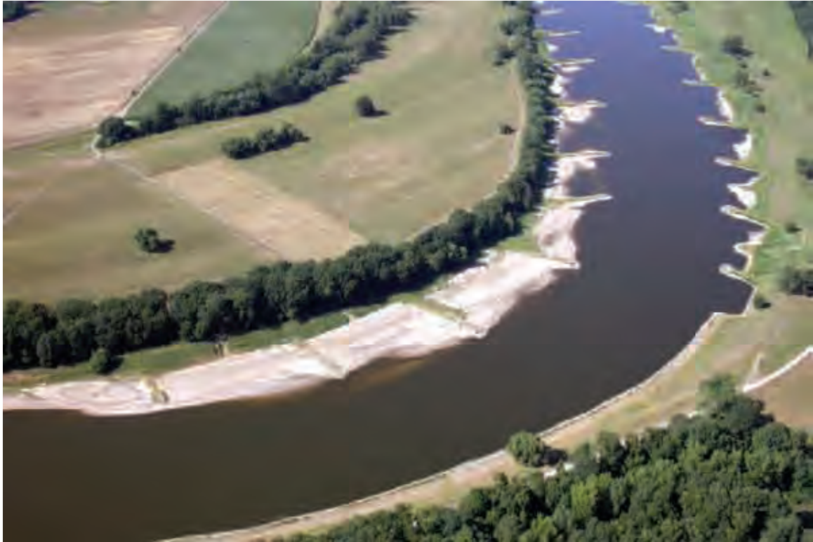
Bild 14: Buhnen (mit z.T. stark verlandeten Buhnenfeldern) und Deckwerk im Prallhang bei El-km 232
