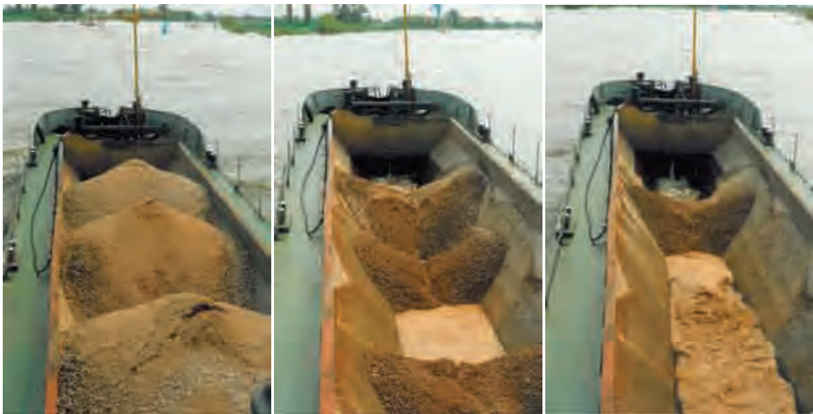
Bild 15: Zugabe des Geschiebetracers „Meißner Granit“ zur Untersuchung des Transportverhaltens von Geschiebezugabematerial
